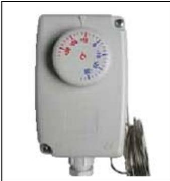
El termostato automáticamente abre (versión calor) o cierra (versión frío) el contacto principal cuando la sonda remota de bulbo alcanza el valor regulado; posteriormente, cuando la temperatura baja del valor del diferencial vuelve a cerrar o a abrir el contacto según la versión.
