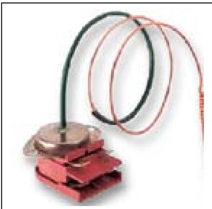
Serie de termostatos de tarado fijo, interruptor simple de apertura por subida de temperatura.
